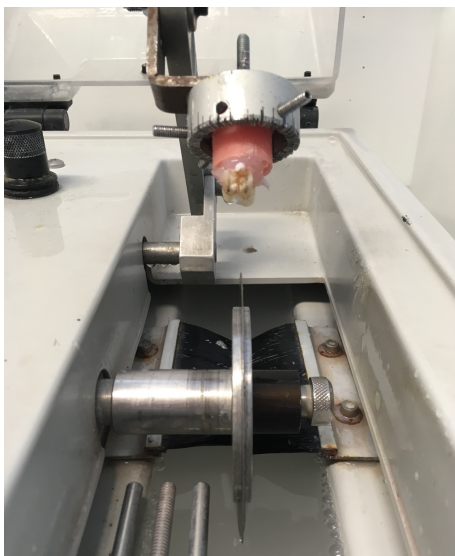
Figura 4 Secção dos dentes: Dente posicionado no micrótopo
