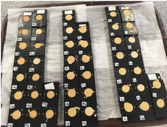
Figura 7 Espécimes montados em placas: Espaço à volta do espécime coberto com gesso dentário
