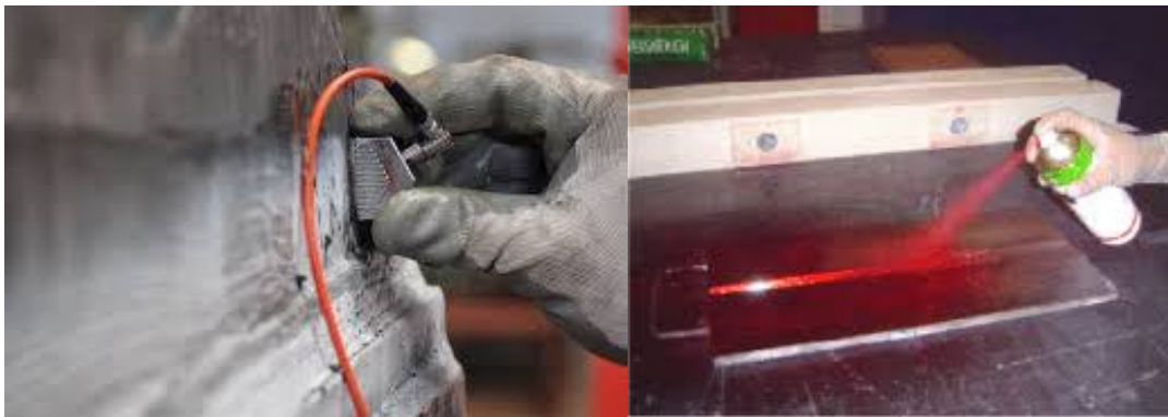
Fig. 3.9 – Representação do teste ultrassom e líquido penetrante, à esquerda e direita, respetivamente.
