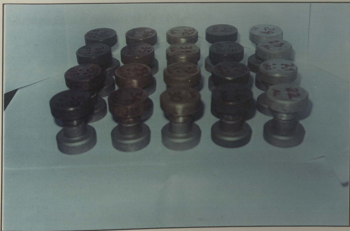
Fot. 7.11 - Montagens coladas de provetes revestidos com contra-provetes (provetes em cima).
