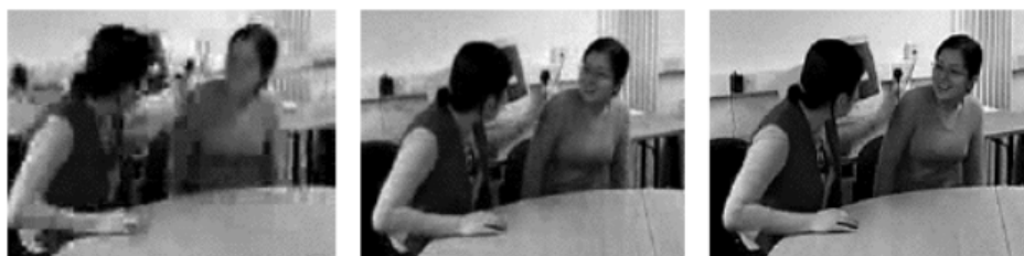
Figura 2.12: Mesmo frame de um vídeo em MPEG-2 (esquerda), MPEG-4 (centro) e h.264/AVC (direita) ao mesmo bitrate de compressão[5]
