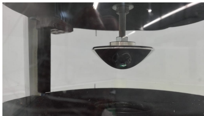
Figura 4.8: espelho concavo diretamente acima da câmara
