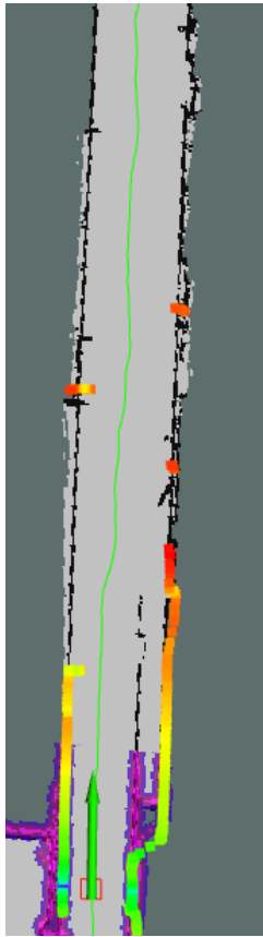
Figura 6.18: Corredor - robô ligeiramente mal localizado
