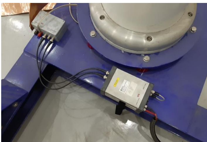
Figura 3.10 - Detetor de DP acoplado na base de sustentação do condensador
