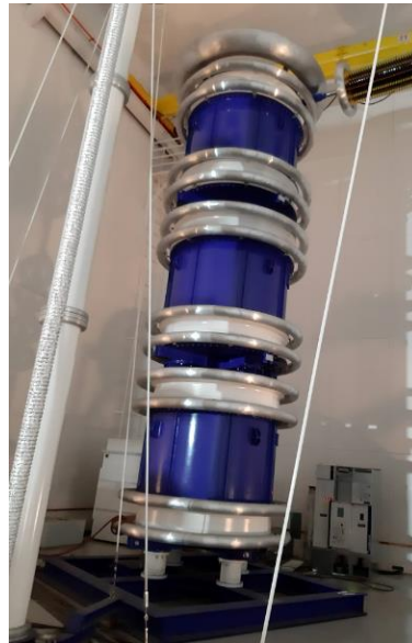
Figura 3.1 - Transformador equipado com um sistema ressonante
