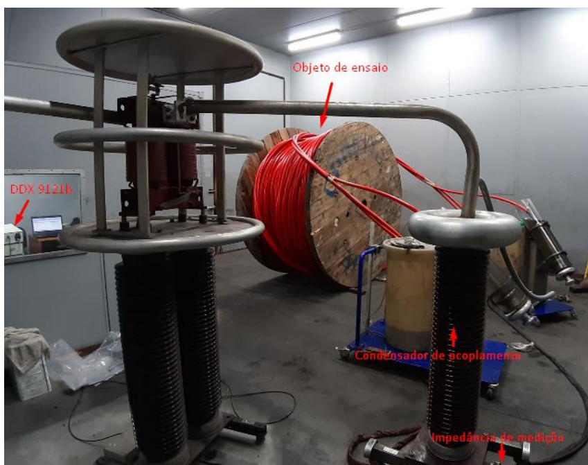
Figura 6.5 - Disposição do circuito de medida
