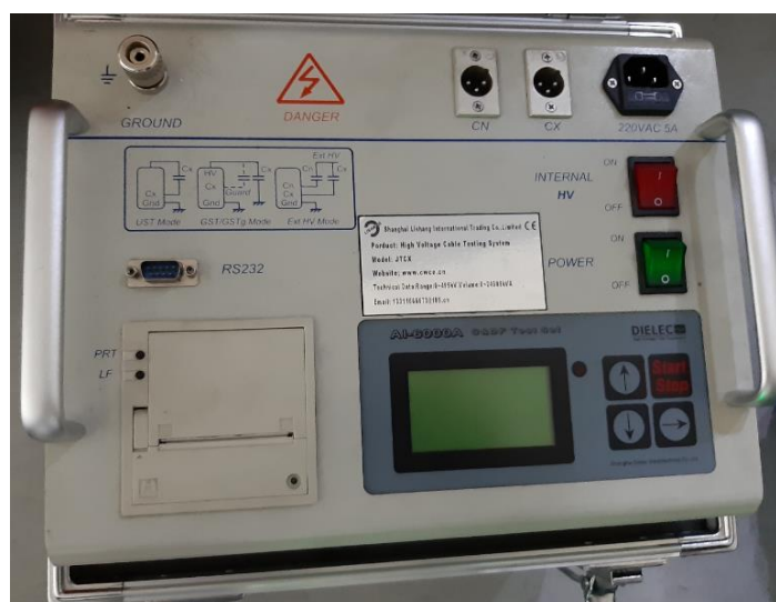
Figura 3.24 - Medidor das perdas dielétricas
