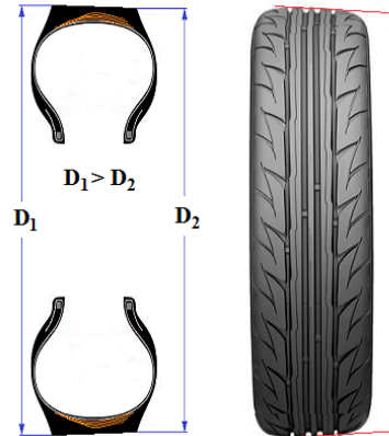
Figura 3.3: Conicidade de um pneu [2].
