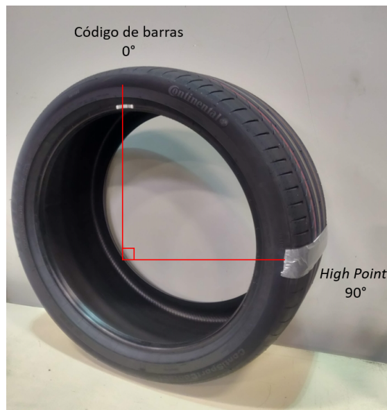
Figura 4.2: Pneu com high point em posição conhecida (90 °).
