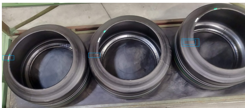
Figura 5.8: Comparação das posições do código de barras e posição de vulcanização em relação à parede que é mantida fixa.
