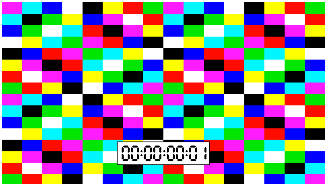
Figura 7.6: Frame na resolução 960 x 540 obtida a partir do testbench (1 link através da resolução original 1080p).
