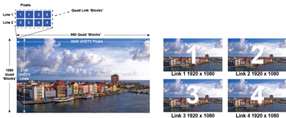
Figura 2.7: Método 2SI para uma resolução 4K. Fonte: [20].
