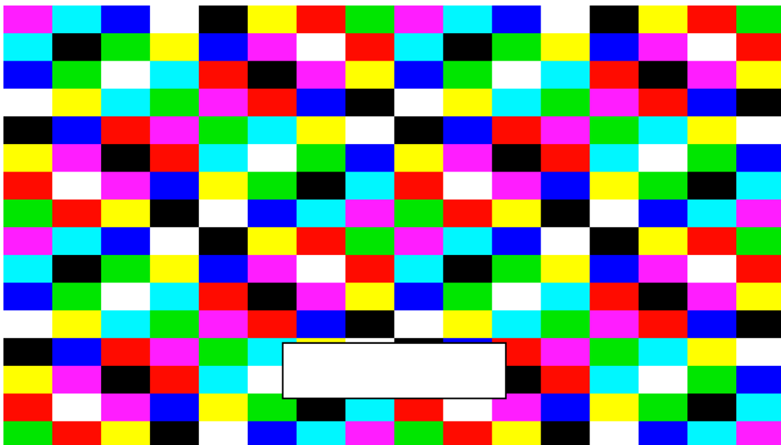
Figura 6.8: Frame 8K retirada do VDMA com o padrão "Tartan Bars" para o teste do fundo para os números.
