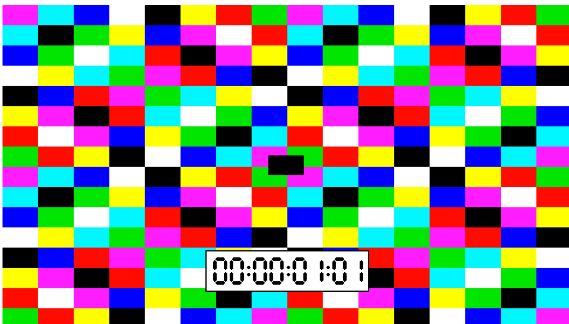
Figura 6.9: Frame 8K retirada do VDMA com o padrão "Tartan Bars" para o teste dos números.
