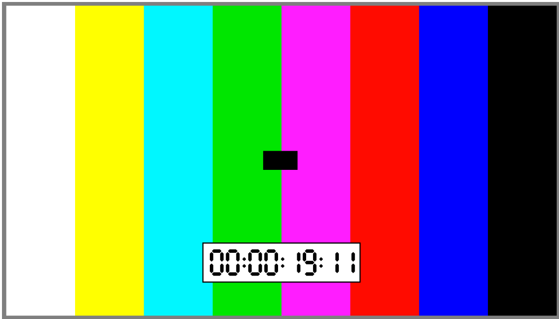
Figura 8.3: Frame 1080p com o padrão "Color Bars" retirada do VDMA do link 1
