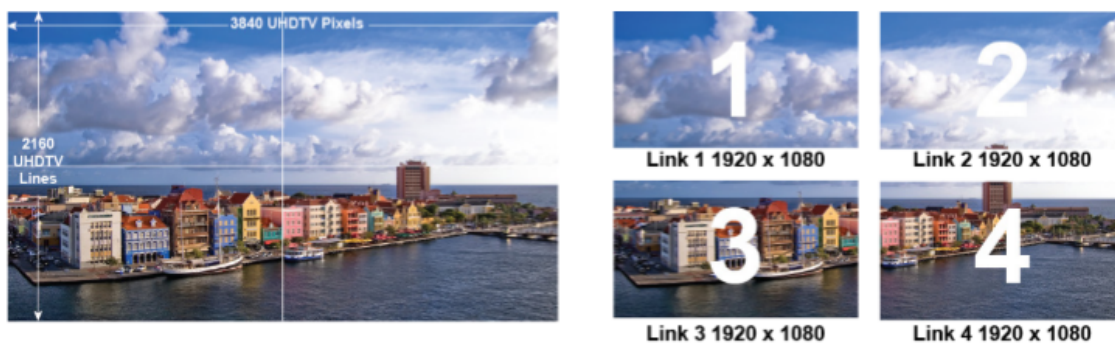
Figura 2.5: Método square division para uma resolução 4K. Fonte: [20].
