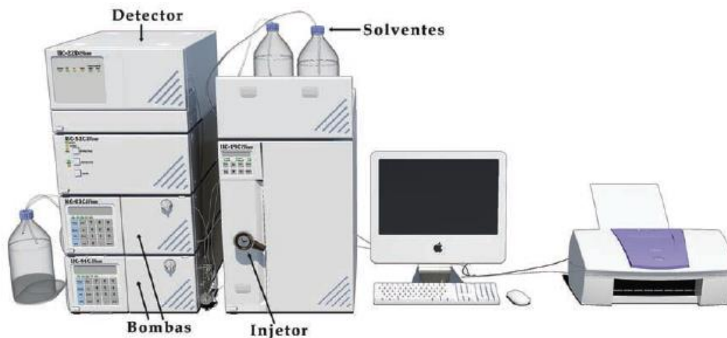
Figura 1: Ilustração das partes principais de um cromatógrafo moderno.
