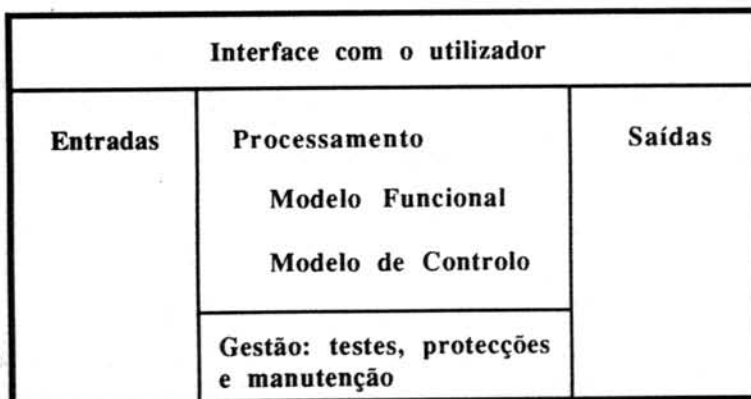
Figura 2-9: Estrutura tipo de um processo
