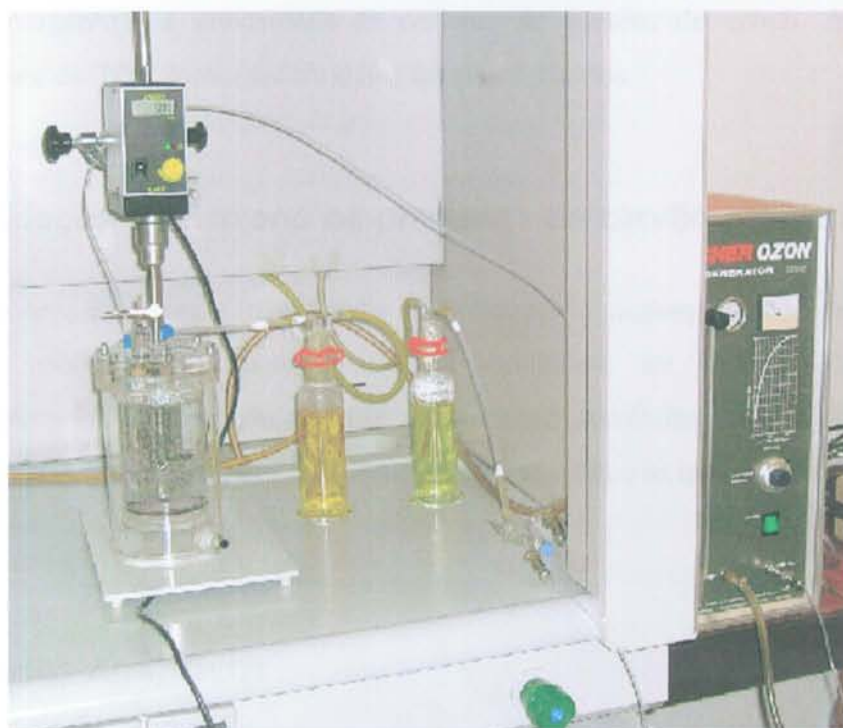
Figura 2.4 Instalação experimental utilizada para a realização dos ensaios cinéticos.
