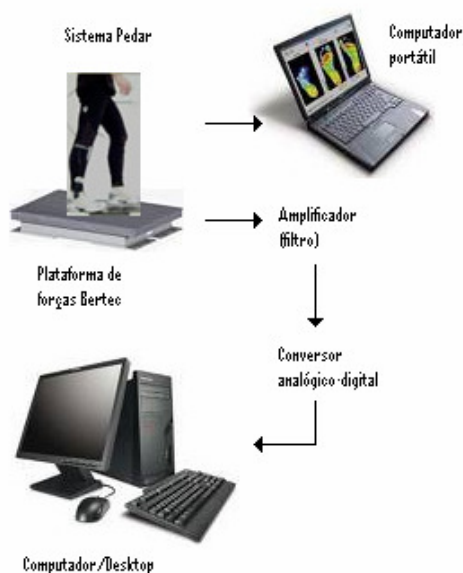
Figura 3.1 – Esquema das relações entre plataforma, sistema de palmilhas e restante material.
