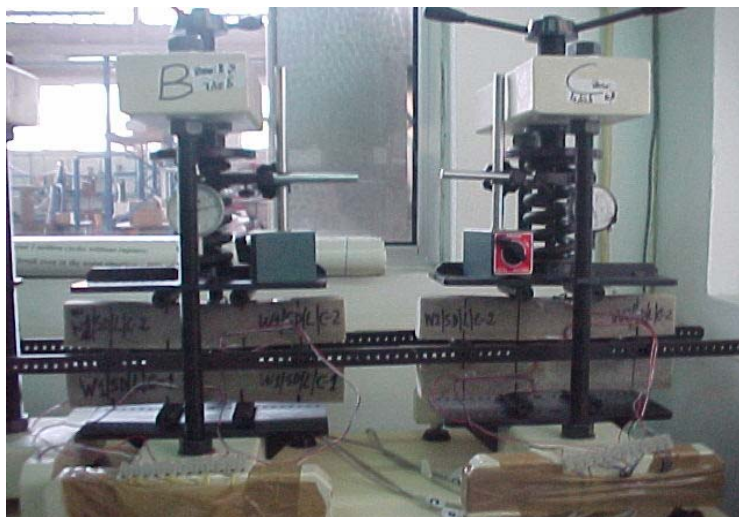
Figura 6.12 – Equipamento para os ensaios de fluência em flexão em 4 pontos; sistema de carregamento simultâneo de duas vigas.
