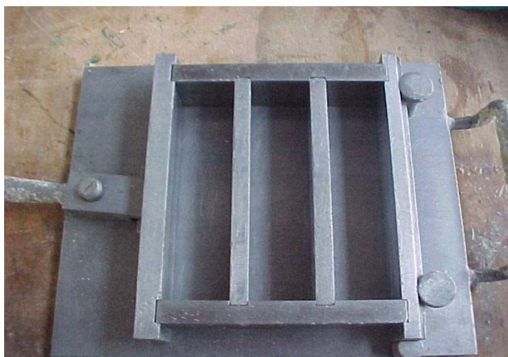
Figura 4.1 – Molde experimental concebido para a produção dos provetes.
