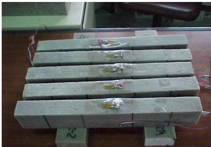
Figura 6.14 – Vigas instrumentadas, destinadas aos ensaios de fluência em flexão em 4 pontos.
