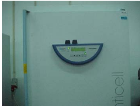
Figura 5.9 – Estufa Venticell onde se fez o tratamento de pós - cura das vigas.
