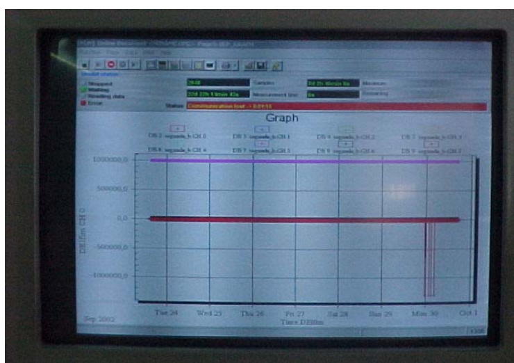
Figura. 6.16 – Ecran onde se vêem algumas curvas de deformação por fluência numa fase de duração superior a 500 h.
