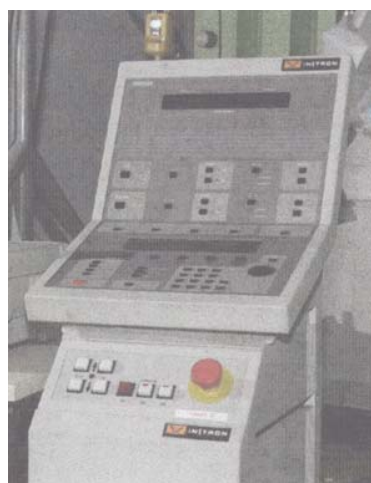
Figura 2.10 – Painel de controle da máquina INSTRON para ensaios de fadiga
