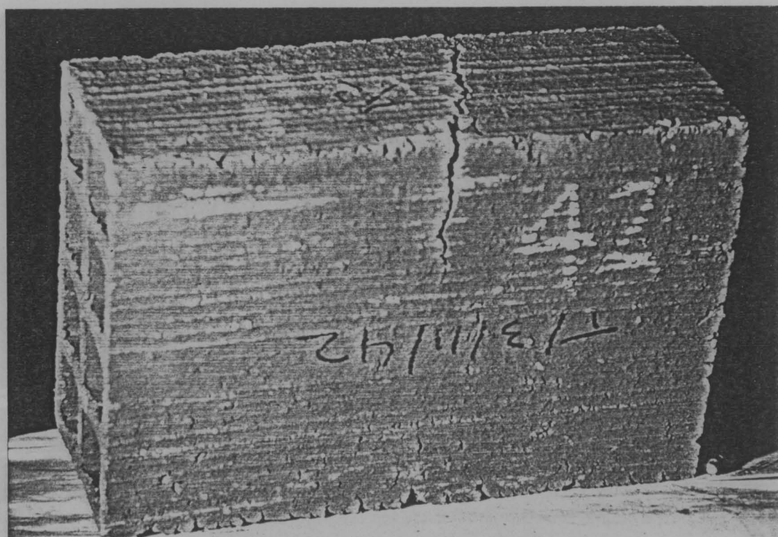
Fig.12 - Bloco cerâmico com fissura transversal exterior
