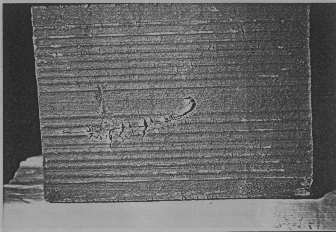
Fig.18 - Bloco cerâmico com defeito resultante de acidentes na moldagem, ou transporte em verde
