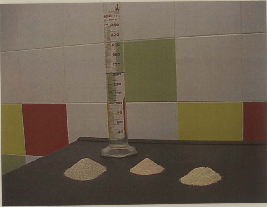
Figura 4.12 – Materiais utilizados na constituição da mistura tipo 13/30/57, a mais utilizada neste projecto de investigação (água destilada, e da esquerda para a direita, areia de quartzo, cfk e caulino)
