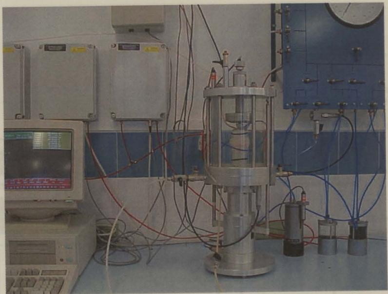
Figura 5.24 – Equipamento utilizado para a realização dos ensaios de corte triaxial
