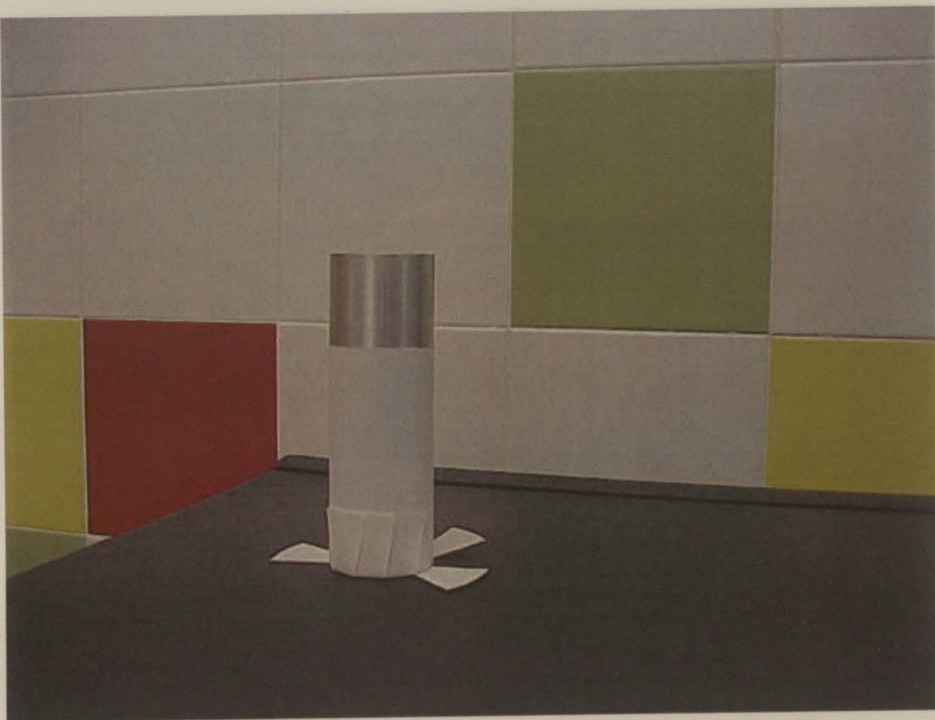
Figura 4.9 – Colagem da peça circular de papel de filtro para formação de uma base
