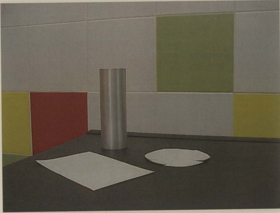
Figura 4.6 – Vista lateral do molde cilíndrico de alumínio e das peças constituintes do molde de papel de filtro
