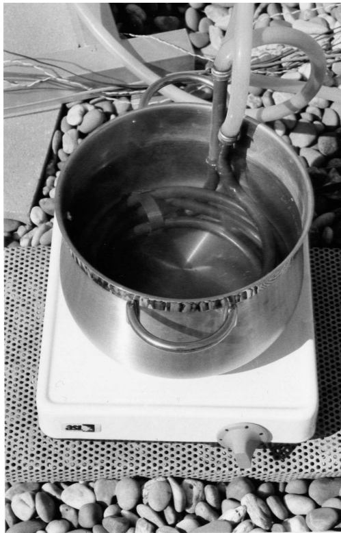
Figura 4.17: Aquecedor eléctrico da água de entrada.
