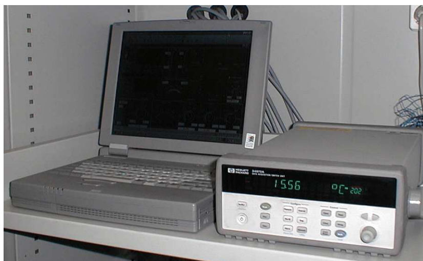
Figura 4.19: Sistema de aquisição de dados e computador.
