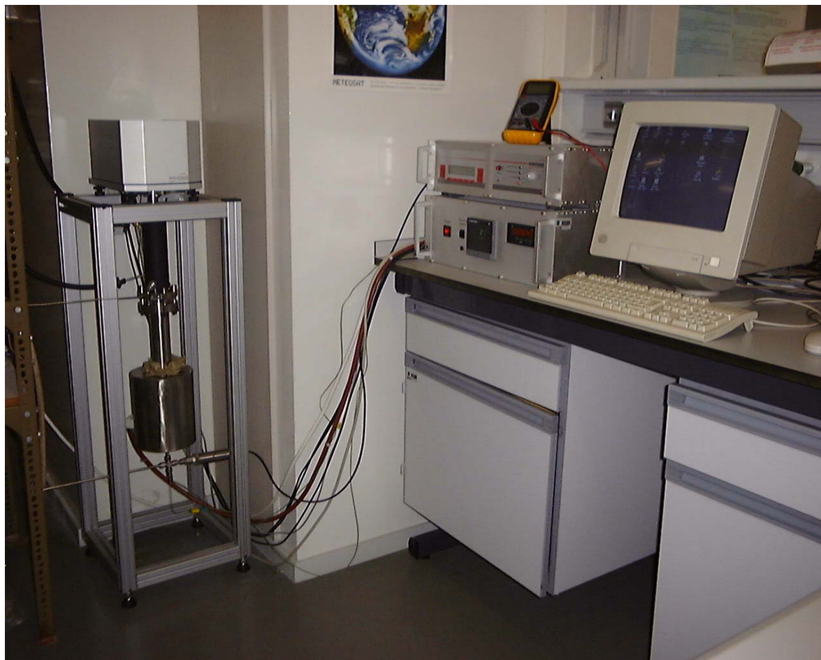
Figura 3.10 – Fotografia do equipamento gravimétrico Rubotherm (Alemanha).
