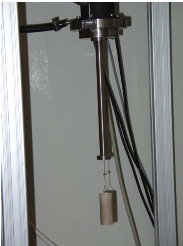
Figura 3.7 – Sistema de medição para alta temperatura: tubo de convecção e cesto de mica.
