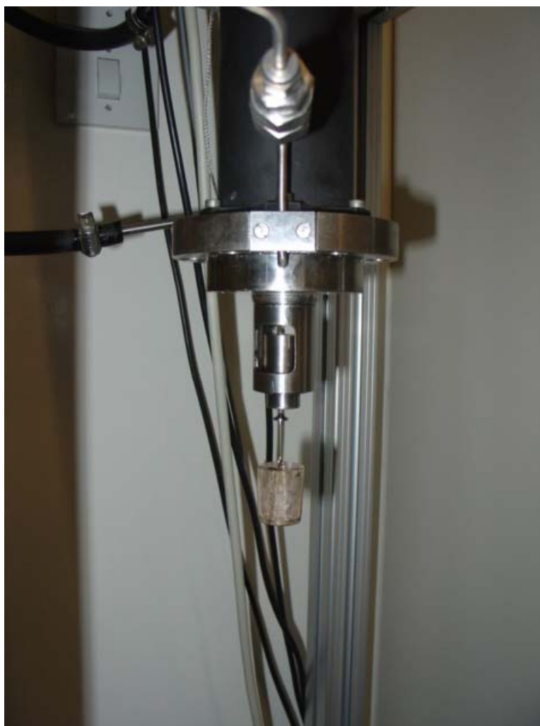
Figura 3.4 – Sistema de medição até T = 423^{\circ}\text{K} : Cesto do adsorvente mais o cilindro de titânio, para a medida simultânea da adsorção e densidade do fluido.
