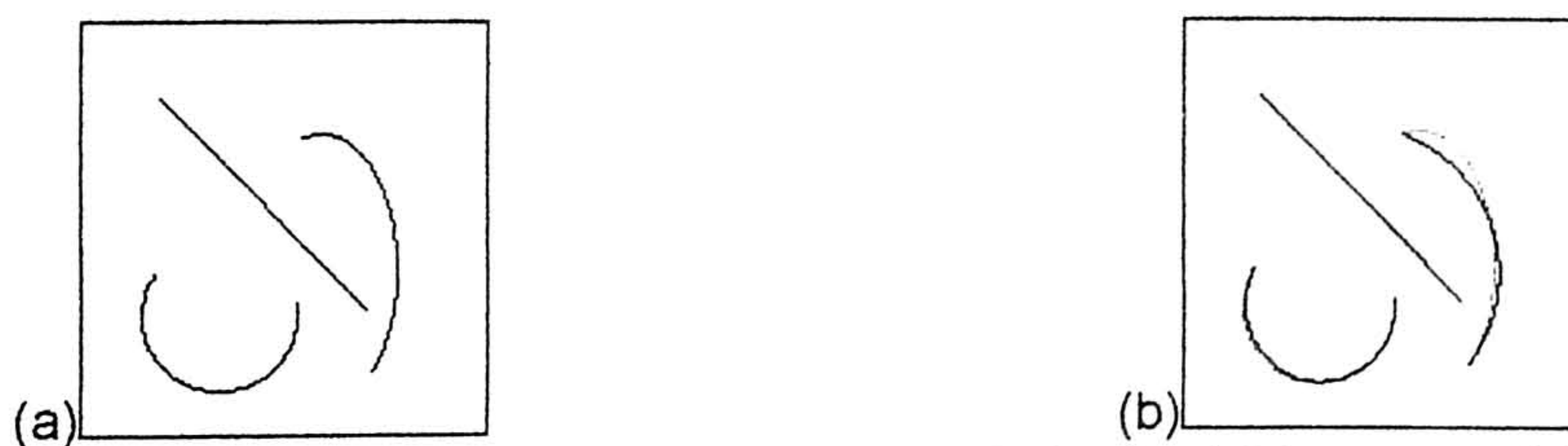
Figura 68: Aproximação de linhas com arcos de circunferência. (a) Imagem original. (b) Aproximação das linhas da imagem original por arcos de circunferência representados num tom mais escuro.
