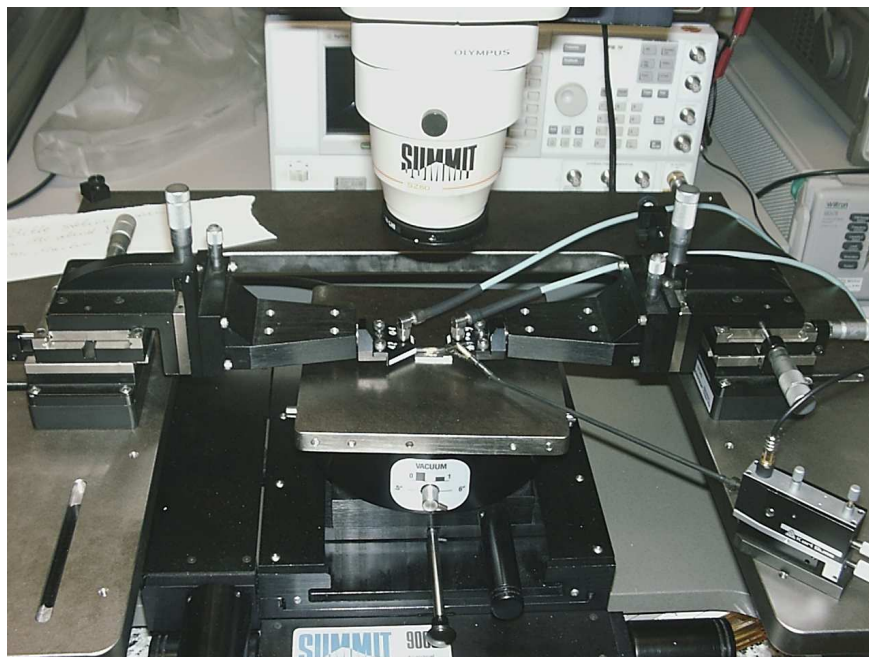
Figura 52: Fotografia da montagem laboratorial utilizada para testar o PA distribuído em tecnologia GaAs.
