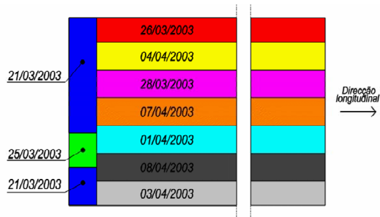
Figura 5.54 – Faseamento das betonagens
