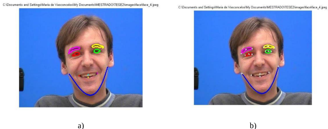
Figura 4.3 Exemplo dos contornos extraídos de uma imagem de face do conjunto de treino (a) e dos pontos-chave automaticamente extraídos (b).
