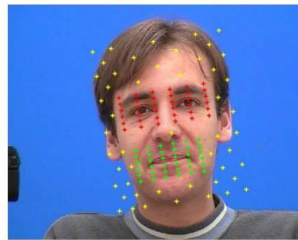
Figura 3.16 Esquema de construção das malhas adaptativas dos tipos 1 e 2 em (a), exemplo de uma malha adaptativa tipo 1 (b) e do tipo 2 (c) aplicada sobre uma imagem do conjunto de treino.
