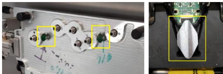
Figura 22 - Máscara de aparafusamento OP 110 e “ gauge ” da OP 240
