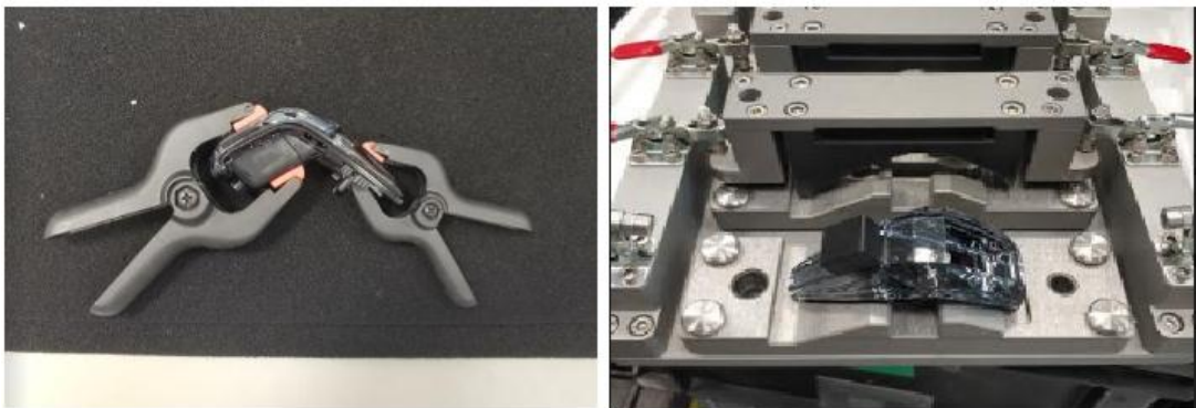
Figura 26 - Processo de calcagem antes e depois de ação de melhoria
