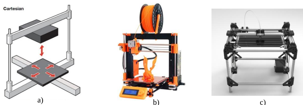
Figura 2.5 - Impressoras FDM com geometria Cartesiana. a) Esquema de movimento impressora cartesiana tradicional [65]; b) Impressora cartesiana Prusa i3 [62]; Impressora Cartesiana Core XY [66].
