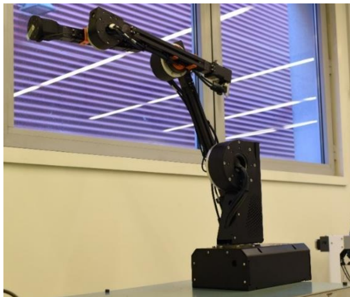
Figura 8.8 - Posição de braço robótico após homing de todas as suas juntas.
