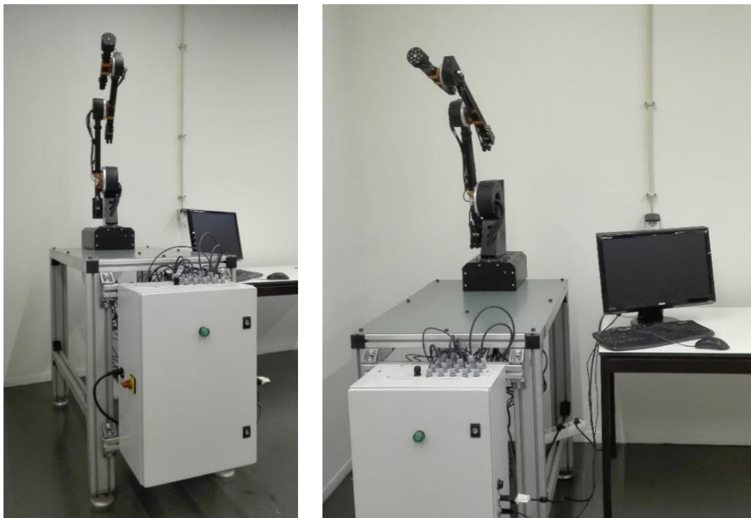
Figura 7.19 - Montagem da estrutura mecânica para o sistema de impressão tridimensional.
