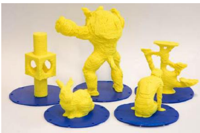
Figura 3.4 - Objetos obtidos por impressão 3D através do sistema RoboFDM em que a decomposição do modelo é baseada num algoritmo de redução de dimensão [95].
