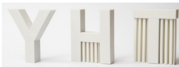
Figura 2.3 - Inclusão de suportes em impressão tridimensional. Imagem sem suporte (à esquerda); Imagem com suportes para superfícies suspensas (centro e direita) [34].
