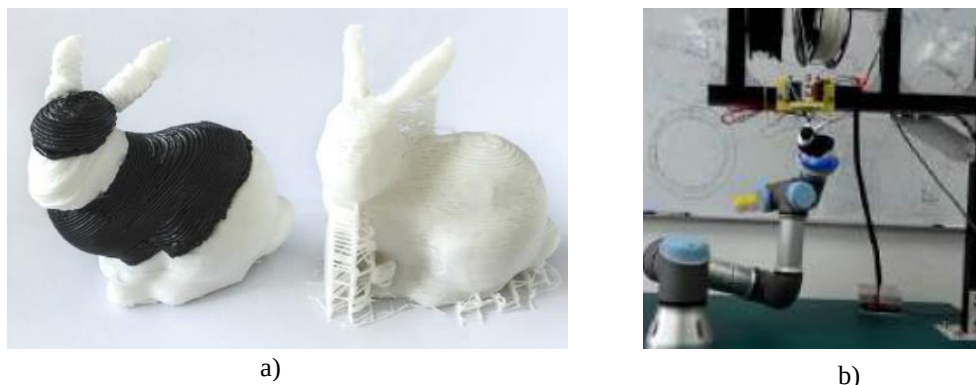
Figura 3.3 - Sistema de impressão 3D RoboFDM . a) Construção de um "coelho", onde é possível observar a divisão do modelo em diferentes regiões (à esquerda) e a construção de um "coelho" com uma impressora 3D convencional (à direita); b) Fase do processo de impressão onde é visível ao extrusor fixo e a base de extrusão móvel [94].
