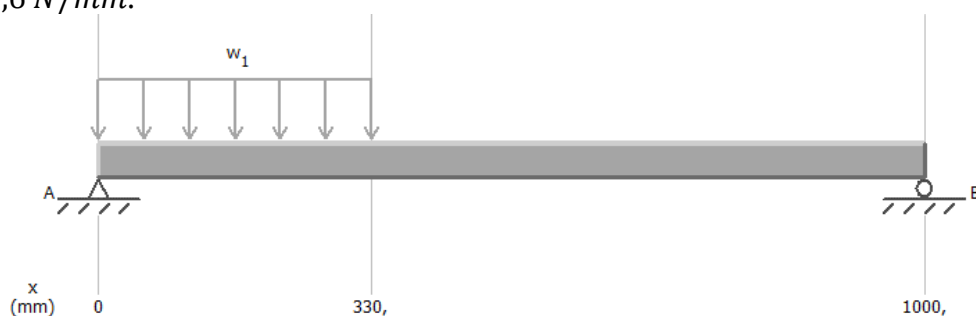
Figura 7.14 - Cargas aplicadas na mesa da estrutura.
