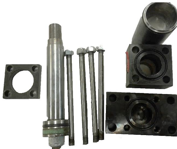
Figura 58- Componentes do cilindro hidráulico.
