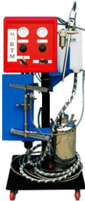
Figura 14 - Máquina de injeção RTM, modelo Hjx-rtm-up de 2 fluidos [21].
