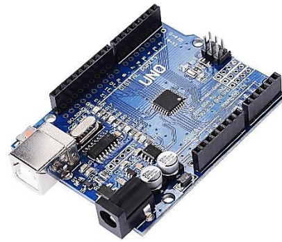
Figura 32 – Microcontrolador Arduino UNO – ATmega328P [38].
