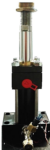
Figura 59 - Setup experimental projetado para medições de compressibilidade.
