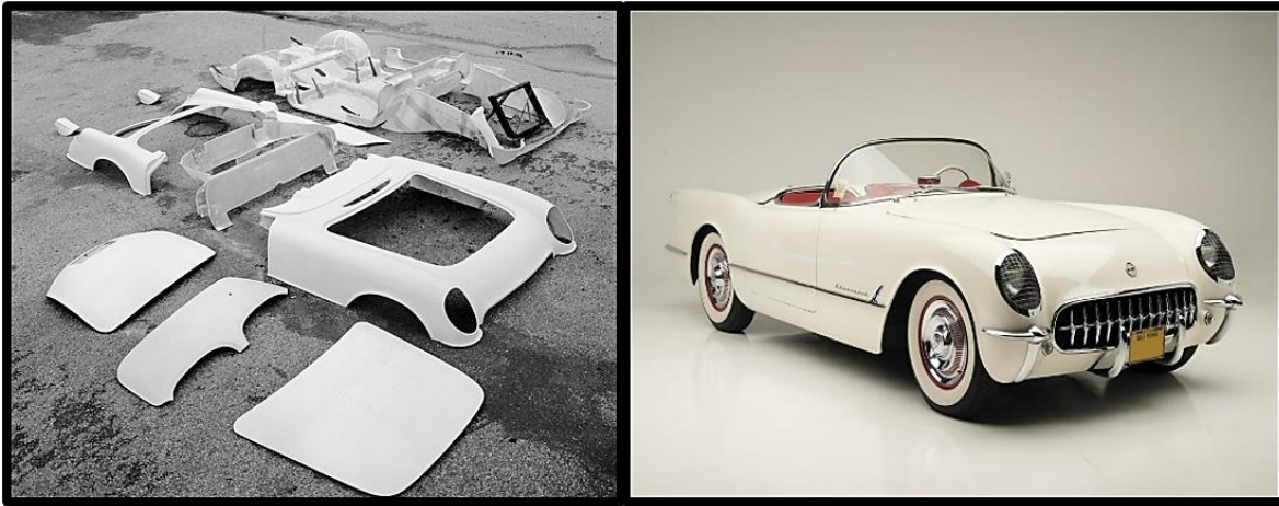
Figura 2 - Carroçaria e painéis em fibra de vidro de um Corvette de 1953 [6],[7].
