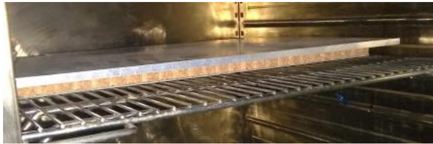
Figura 51 – Pós-cura do adesivo a 50 °C durante 4 h.
