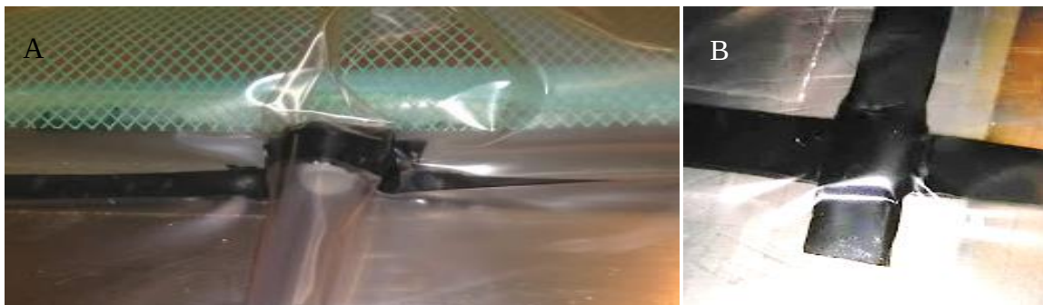
Figura 29 - Zonas críticas pela possível entrada de ar durante a criação de vácuo: A) bocal; B) sobreposição do adesivo).
