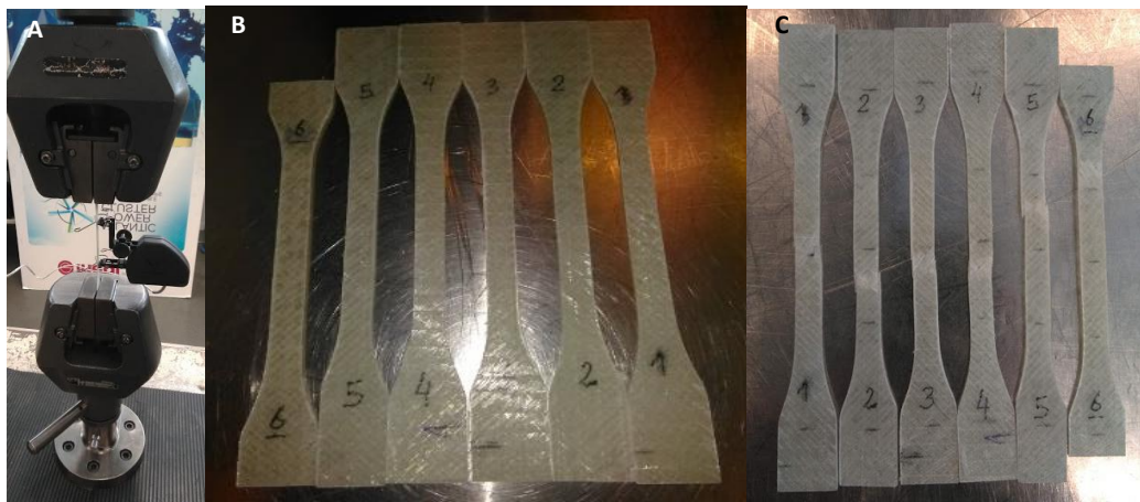
Figura 33 – A) Ensaio de tração na Instron® 5900R®; B) Provetes para determinação das propriedades do compósito de fibra de vidro usado; C) Provetes depois de tracionados.
