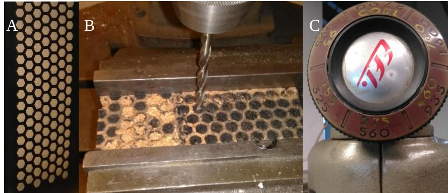
Figura 43 – A) Máscara usada para a furação; B) Furação da placa de teste; C) Ajuste da velocidade.
