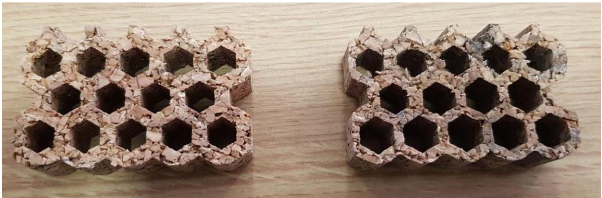
Figura 48 - Corte executado a jato de água (esquerda - sem agente abrasivo; direita - com agente abrasivo).
