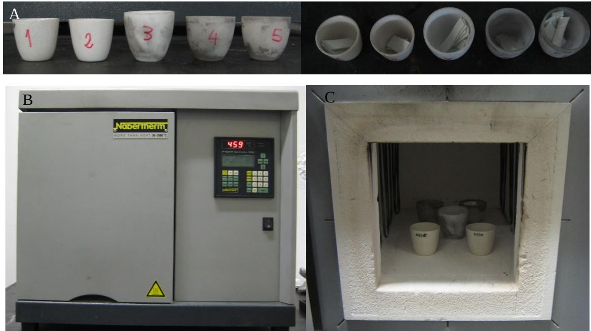
Figura 32 – A) Cadinhos com resíduos das amostras de compósito em FV; B) Mufla Nabertherm; C) Cadinhos no interior da mufla, após calcinação das amostras de compósito de FV.
