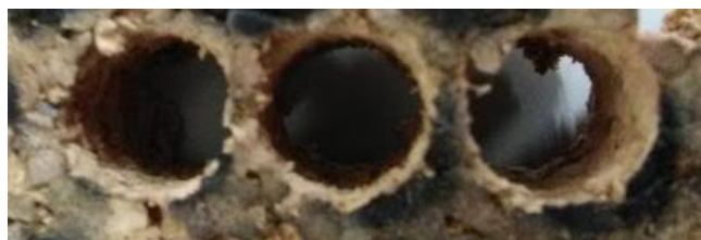
Figura 45 - Furos de 8 mm de diâmetro, à entrada da broca, realizados a 2700 rpm.
