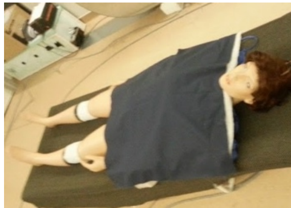
Figura 8. Tecidos colocados sobre o manequim térmico
