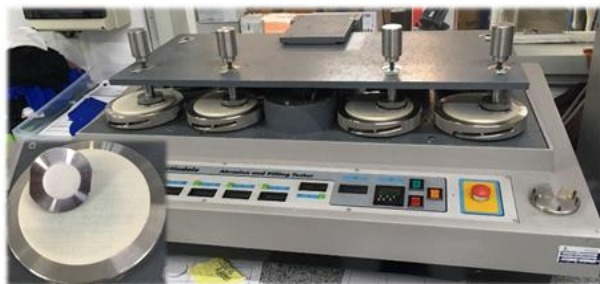
Figura 12 - Equipamento Martindale preparado para o teste de abrasão.
