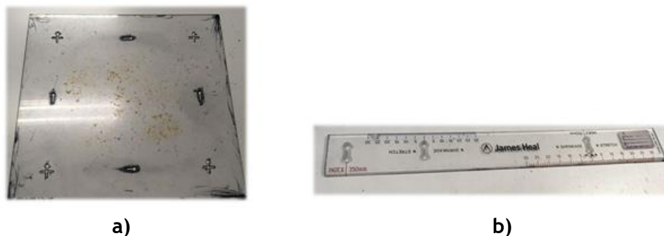
Figura 9 - a) Esquadro usado para fazer as marcações dos testes de estabilidade dimensional e espiralidade. b) Régua usada para medir os valores de encolhimento e torção das malhas.
