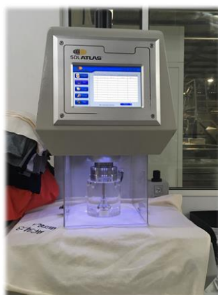
Figura 13 - Eclatómetro de membrana pneumática utilizado para o estudo da resistência ao rompimento.
