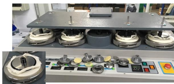
Figura 11 - Equipamento Martindale preparado para o teste de formação de borbotó.
