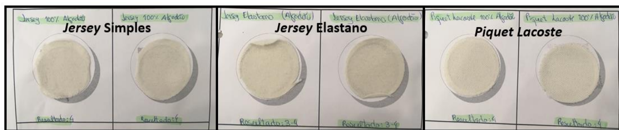
Figura F.4 - Resultados obtidos para o teste de abrasão em malhas com título 30/1 Ne no estudo das fibras de algodão.
