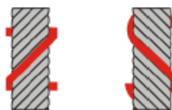
Figura 3 - Direções da torção Z e S. [20]
