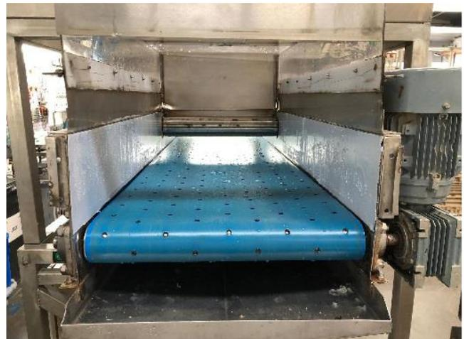
Figura 13- Moega de descarga das rolhas e tapete rolante
