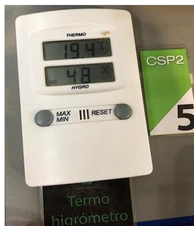
Figura 18- Termo Higrómetro (Aparelho de medição de temperatura e humidade)
