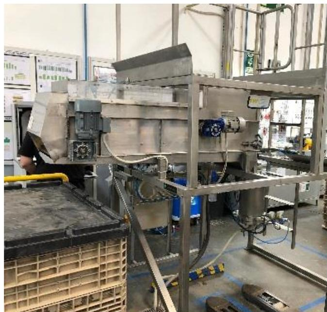
Figura 10- Máquina de Humidificação de Rolhas
