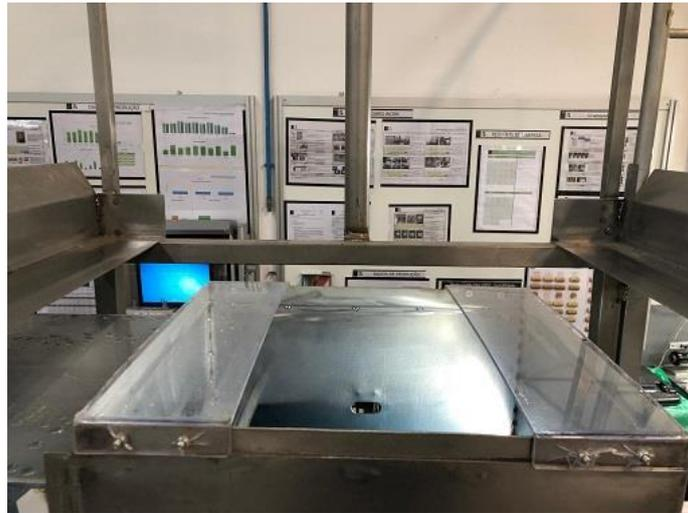
Figura 11 – Moega de carga das rolhas na máquina
