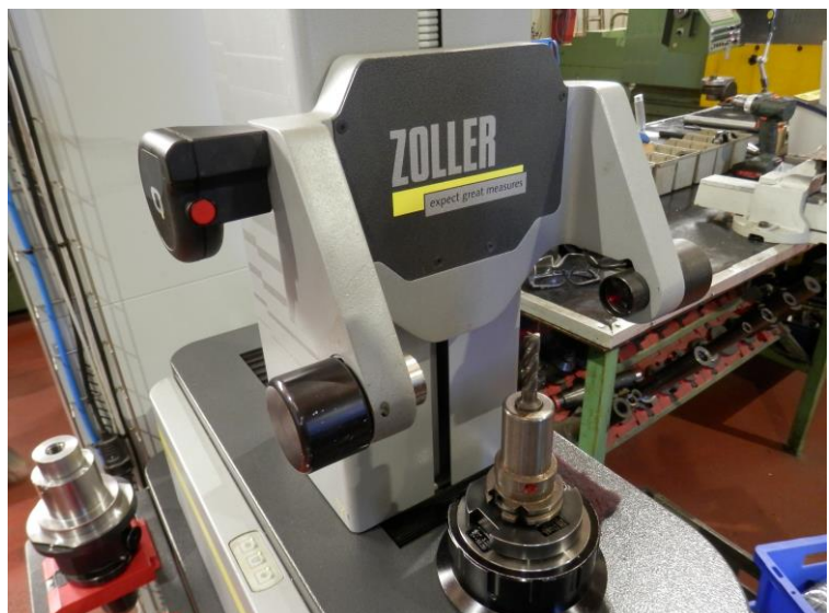
Figura 32 - Máquina de medição Zoller.
