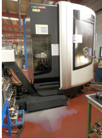
Figura 15 - Detecção de fuga do fluido de corte.
