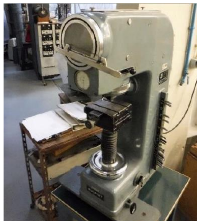
Figura 58- Durómetro Die Testor 2 RC presente no laboratório de ensaios tecnológicos do DEMec
