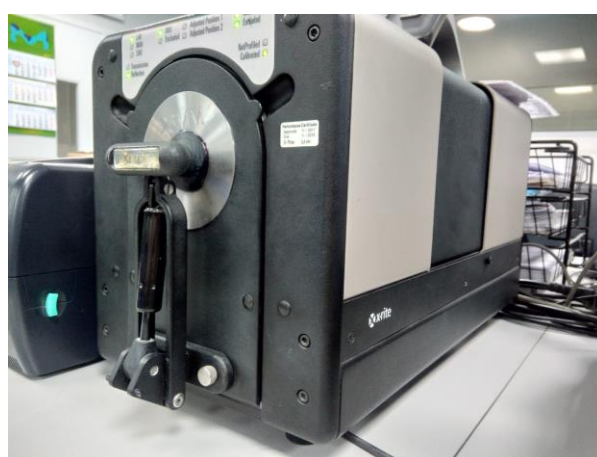
Figura A.11 - Espectrofotômetro de bancada para avaliação da cor.
