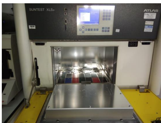
Figura A.15 - Câmara de envelhecimento acelerado com lâmpada de xénon do laboratório do LEPABE, no UPTec.
