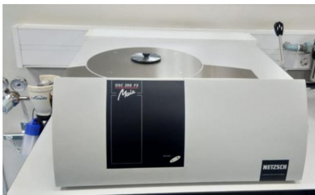
Figura A.9 - Equipamento de DSC utilizado para a determinação da T_g .
