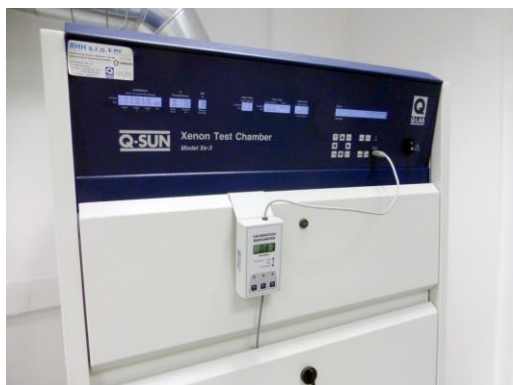
Figura A.13 - Câmara de envelhecimento acelerado com lâmpadas de xénon.
