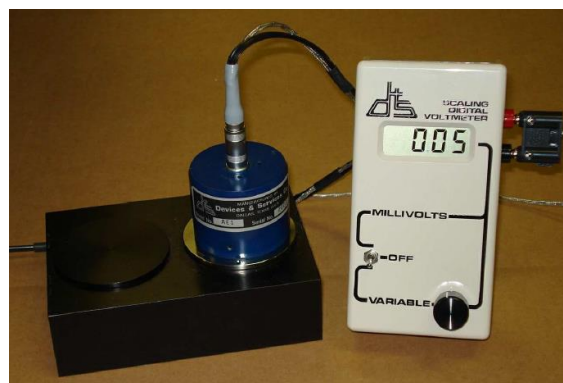
Figura A.8 - Emissómetro utilizado para a determinação da emissividade.
