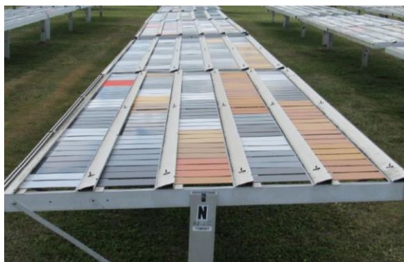
Figura A.6 - Banco de exposição com inclinação de 5 °. [31]
