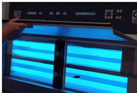
Figura A.14 - Câmara de envelhecimento acelerado com lâmpadas UV.
