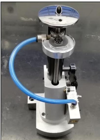
Figura 20 - Cabeça de robô
