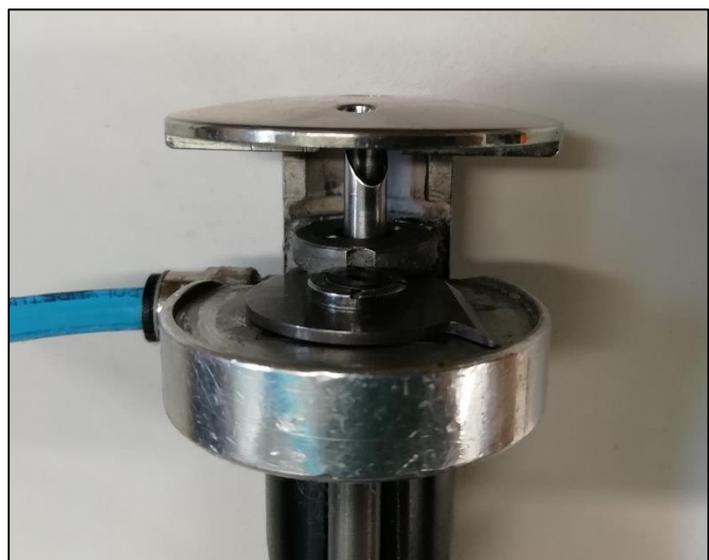
Figura 21- Calcador, bico e lâmina
