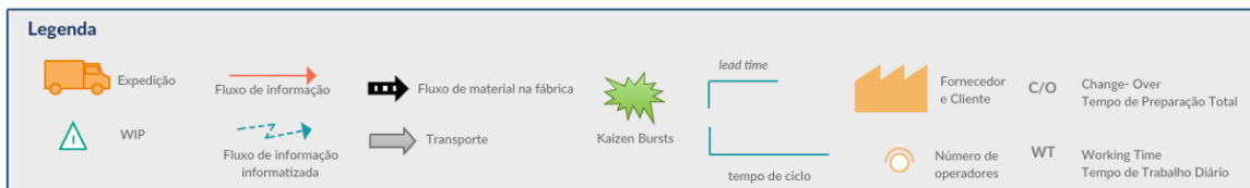
Figura 6 Simbologia para o mapeamento do fluxo de valor
