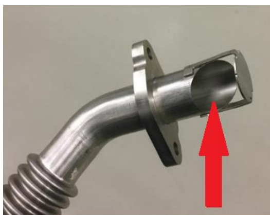
Figura 24 - Zona do tubo 1739 com elevada frequência de não-conformidades
