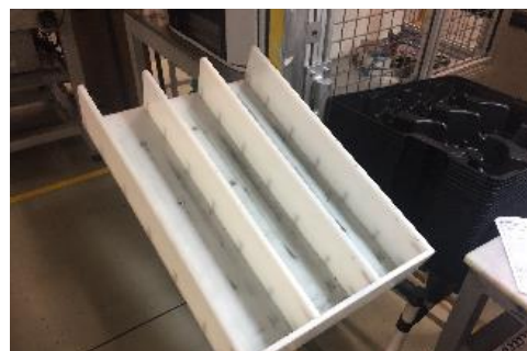
Figura 83 - Suporte para tubos entre postos noutra célula da fábrica
