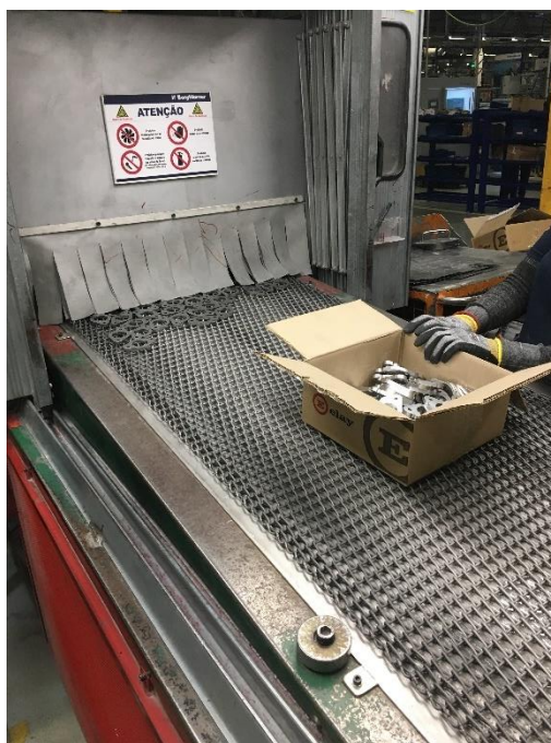
Figura 25 - Flanges à saída do tratamento no forno
