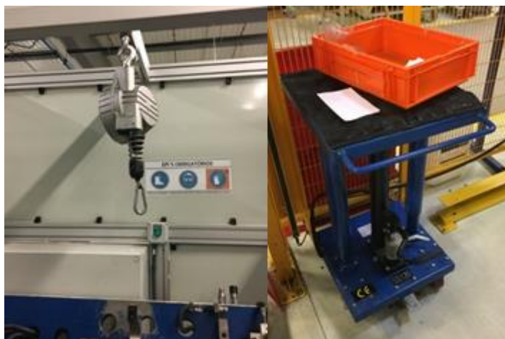
Figura 82 - Guincho para ferramentas pesadas e plataforma com ajuste de altura por pedal
