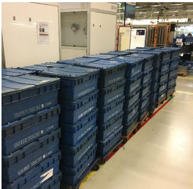
Figura 16 - Corredor ocupado que impede alimentação entre máquinas 4 e 5
