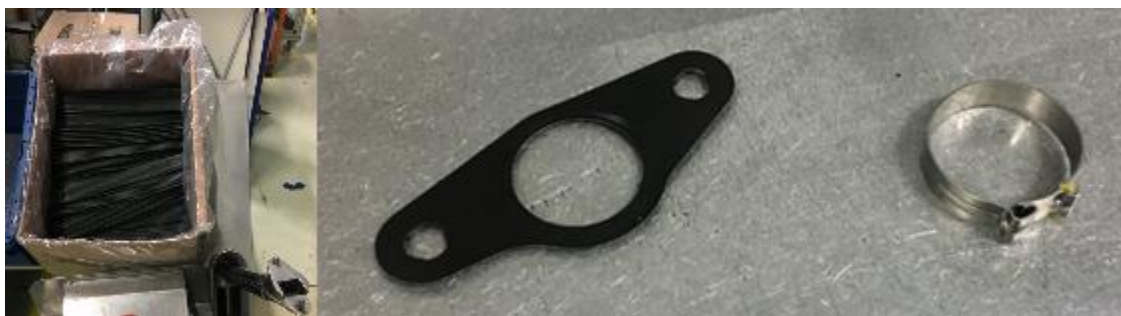
Figura 28 - Mangas de resistência térmica (à esquerda), junta (ao centro) e braçadeira (à direita)
