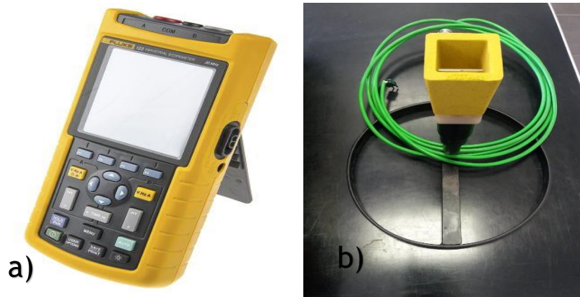
Fig. 7 - a) Osciloscópio, e b) Copo de análise térmica e cabo de ligação ao osciloscópio.
