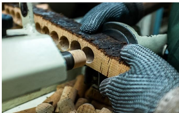
Figura 17. Processo de Brocagem[31]
