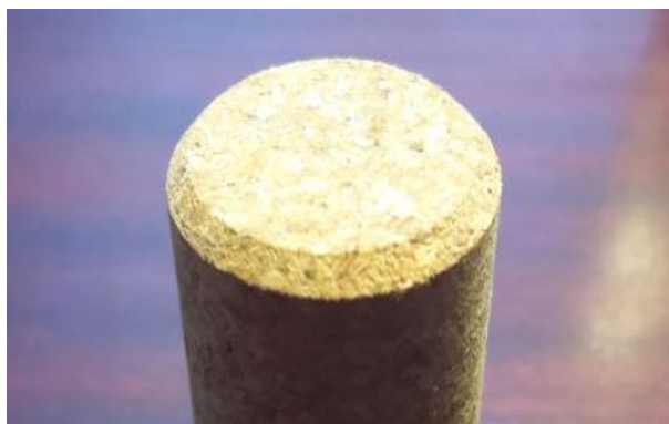
Figura 23. Chanfro das rolhas técnicas (Fotografia de uma rolha produzida na CSP)
