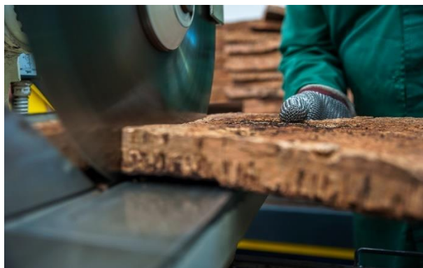
Figura 16. Processo de rabaneação das pranchas de cortiça[31]
