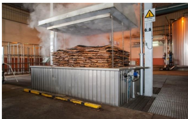
Figura 14. Processo de cozedura das pranchas de cortiça[31]
