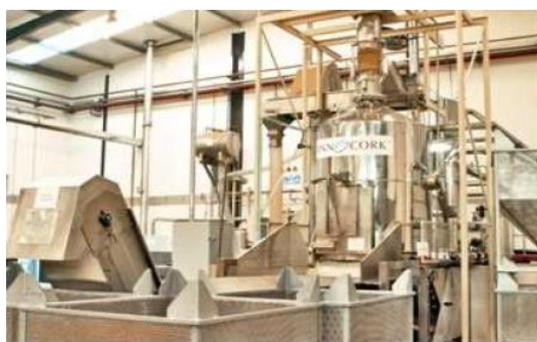
Figura 19. Processo Innocork® de desodorização das rolhas[33]
