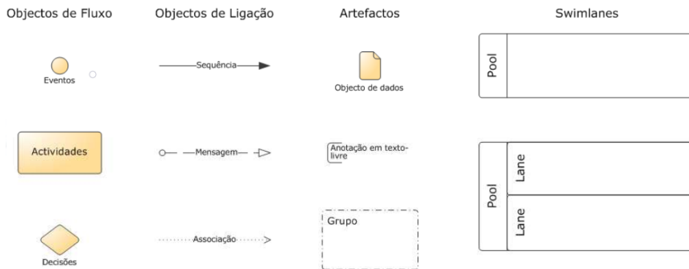
Figura 2.1: Elementos gerais da notação BPMN. Adaptado de [NF12]
