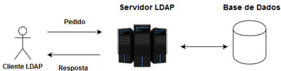
Figura 2.2: Pedido a servidor LDAP
