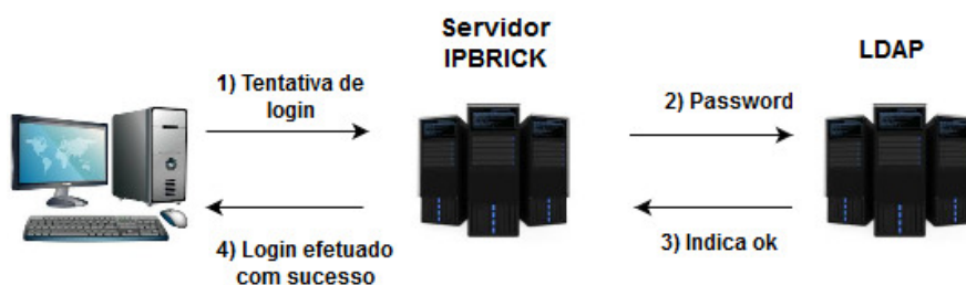
Figura 3.2: Exemplo de um pedido LDAP
