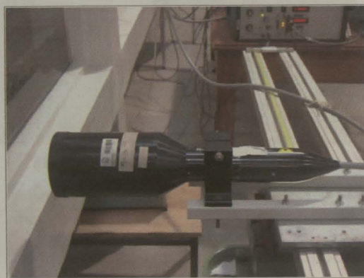
Fotografias 5.30 e 5.31 - Equipamento Laser OMNICHROME - Lentes de distância focal 300 mm e 600 mm
