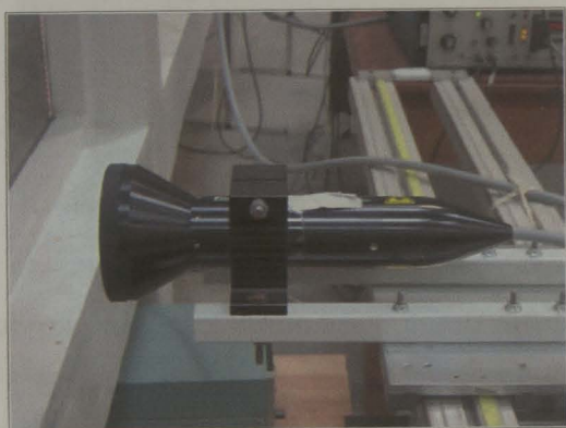
Fotografias 5.30 e 5.31 - Equipamento Laser OMNICHROME - Lentes de distância focal 300 mm e 600 mm
