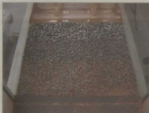
Fotografia 7.7 - Fossa de erosão final (vista de cima)
