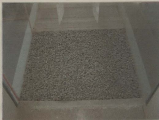
Fotografias 4.14 e 4.15 - Vista do tapete de enrocamento, à data dos primeiros ensaios, para verificação do funcionamento do modelo
