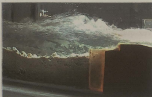
Fotografia 6.38 - Vista da fossa criada pelo escoamento com abertura superior do vão lateral
