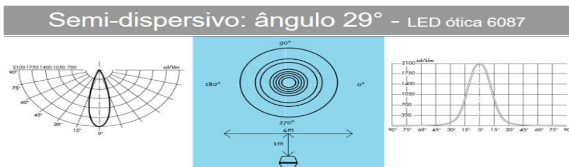
Figura 4.17 - Fotometria do Projetor Enyo LED Proposto [73]
