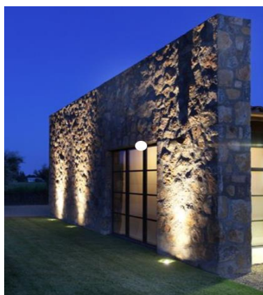
Figura 3.1 - Ilustração da Iluminação Efeito Wall Washing [55]
