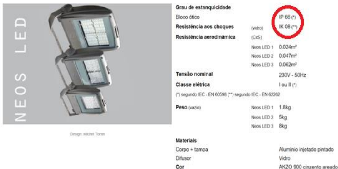
Figura 4.24 - Luminária Neos LED 1 e Respetivas Características [75]
