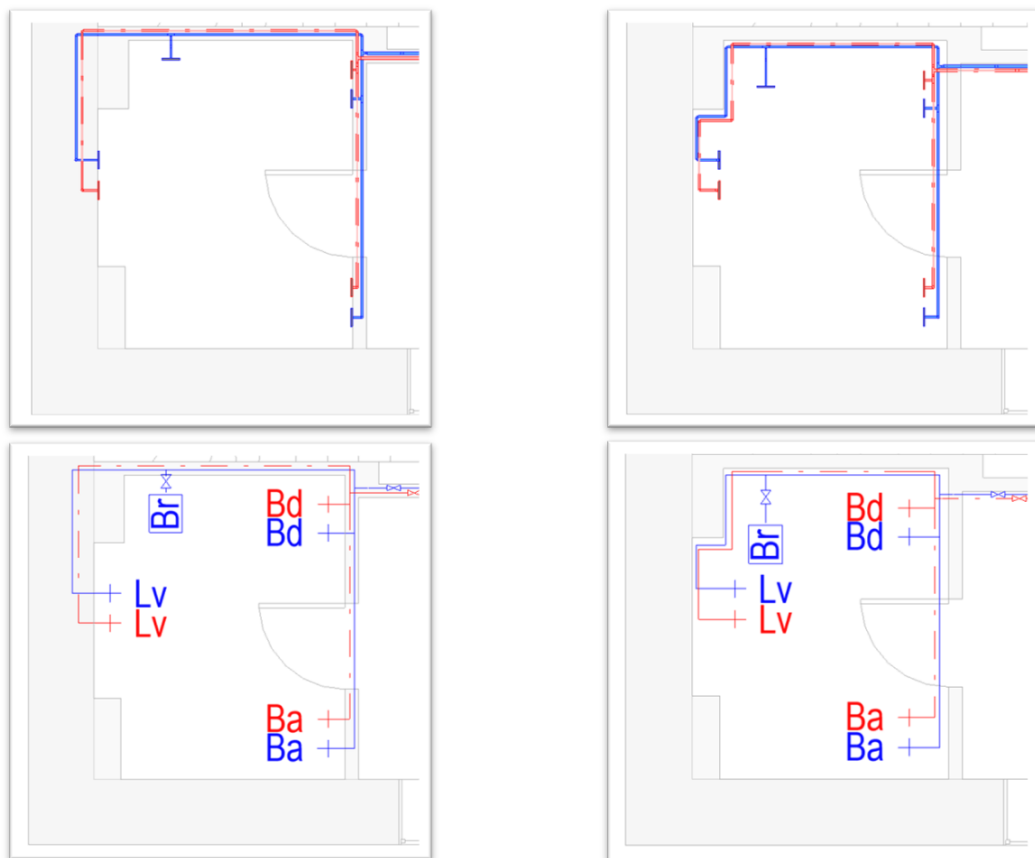
Figura 7 – Representação diretamente a partir do modelo de coordenação (esquerda). Representação automática de desenhos conforme tradicionalmente representado (direita).
