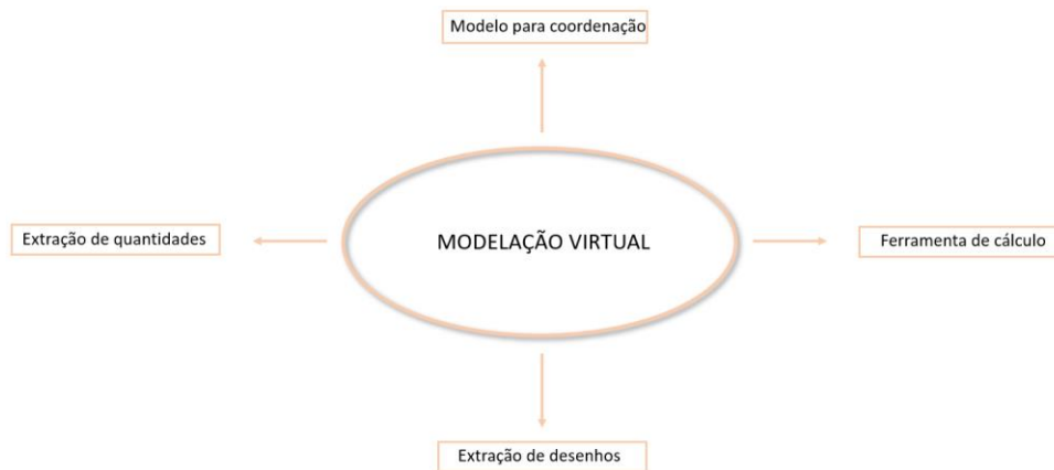
Figura 5 - Representação esquemática de algumas potencialidades da modelação virtual
