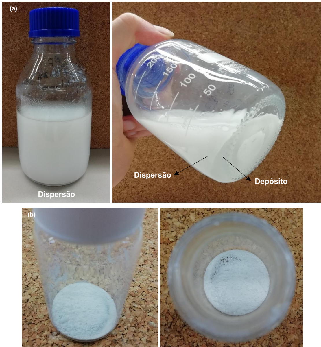
Figura 30. Imagens dos produtos obtidos segundo a síntese 3 pelo método de post-grafting : (a) Dispersão de TEOS 1 h + F 1 1 h e depósito; (b) Pó de TEOS 1 h + F 1 1 h após a secagem.
