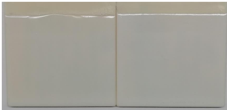
Figura 62. Placas de ABS cobertas pelo verniz aditivado com as NPs de TiO 2 comerciais.
