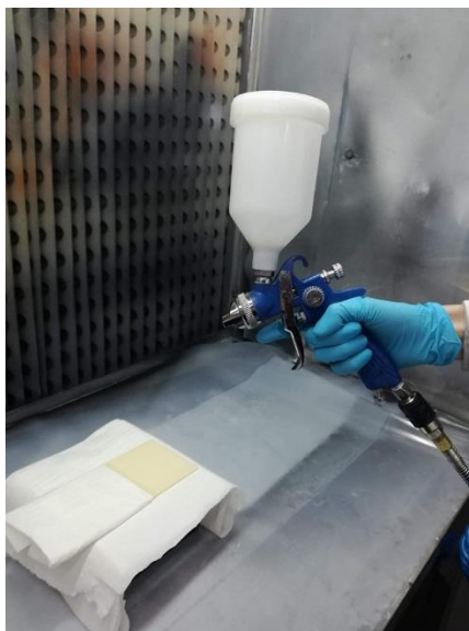
Figura 21. Ilustração da aplicação dos vernizes aditivados a substratos poliméricos de ABS por spray coating .
