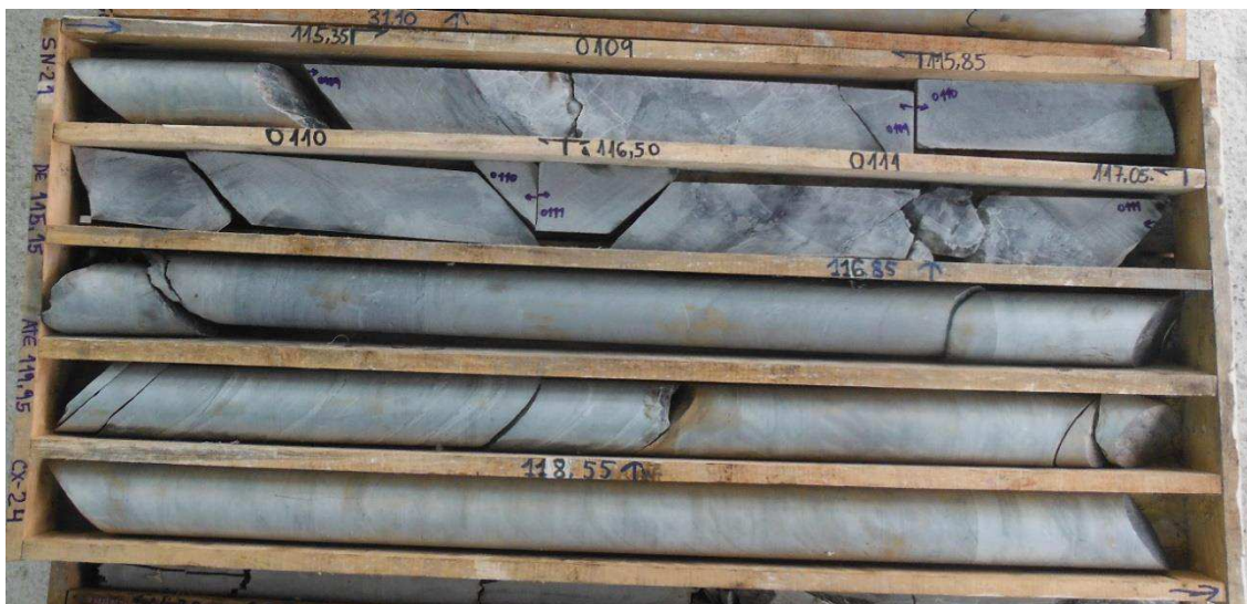
Figura 40: Caixa nº24 da sondagem SN-21. A tinta azul está marcada a informação relativa ao posicionamento da sondagem, em particular metragem inicial e final da manobra, o número da caixa e o nome da sondagem. A tinta preta estão marcadas as informações relativas à amostragem, como por exemplo a metragem inicial e final de cada amostra, e entre estas medidas a referência da amostra, sendo neste caso um número.
