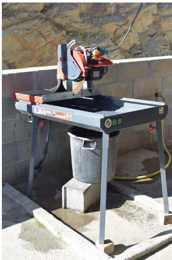
Figura 41: O uso de uma serra elétrica como a da figura garante um corte exato da amostra de rocha. A serra da figura recorre a um sistema de arrefecimento com água, pelo que implica que todas as partículas finas resultantes do corte serão capturadas e retidas no tabuleiro inferior. Deve ser estabelecido se é ou não relevante capturar esta fração mineral., a qual poderá conter indícios de mineralização.
