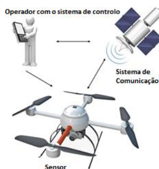
Fig.1 - Representação da composição e modo de funcionamento dos VANT.
