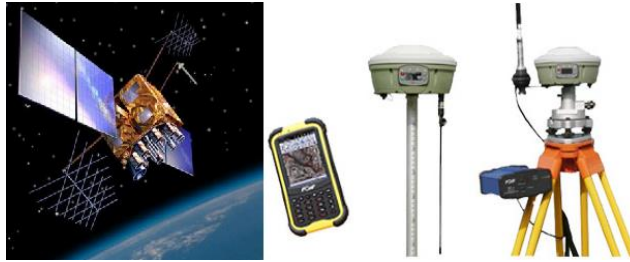
Fig.5 - (a) Satélite de uma constelação; (b) Recetores de sinais GPS.
