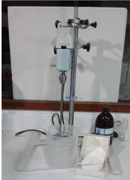
Figura 4 – Material usado no ensaio: bureta, papel de filtro, vara de vidro, agitador de hélice, gobelé de vidro ou plástico.
