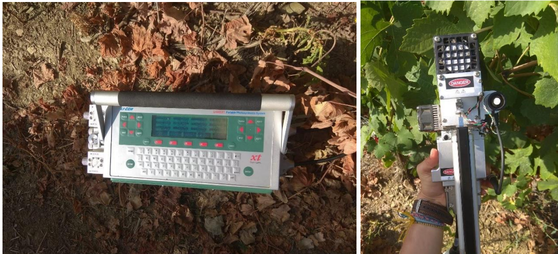
Figura 17: Aspeto da unidade de tratamento de dados e da câmara de Parkinson que constituem o dispositivo IRGA
