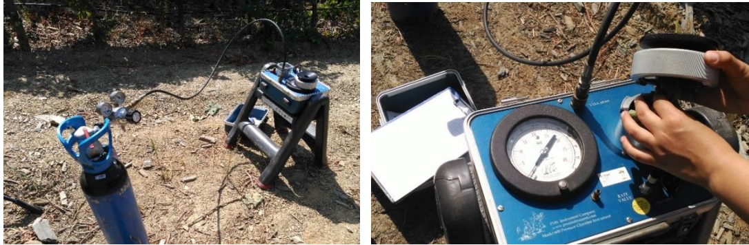
Figura 14: Aspeto da câmara de Schölander com botija de gás acoplada e colocação da folha (pecíolo) na válvula da câmara de Schölander.
