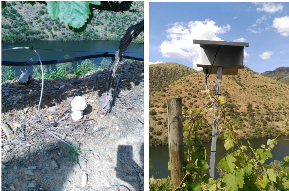
Figura 9: Sonda EnviroSCAN® 150, que monitoriza a humidade do solo a diferentes profundidades e unidade de comunicação que trata e envia os dados recolhidos pela sonda.
