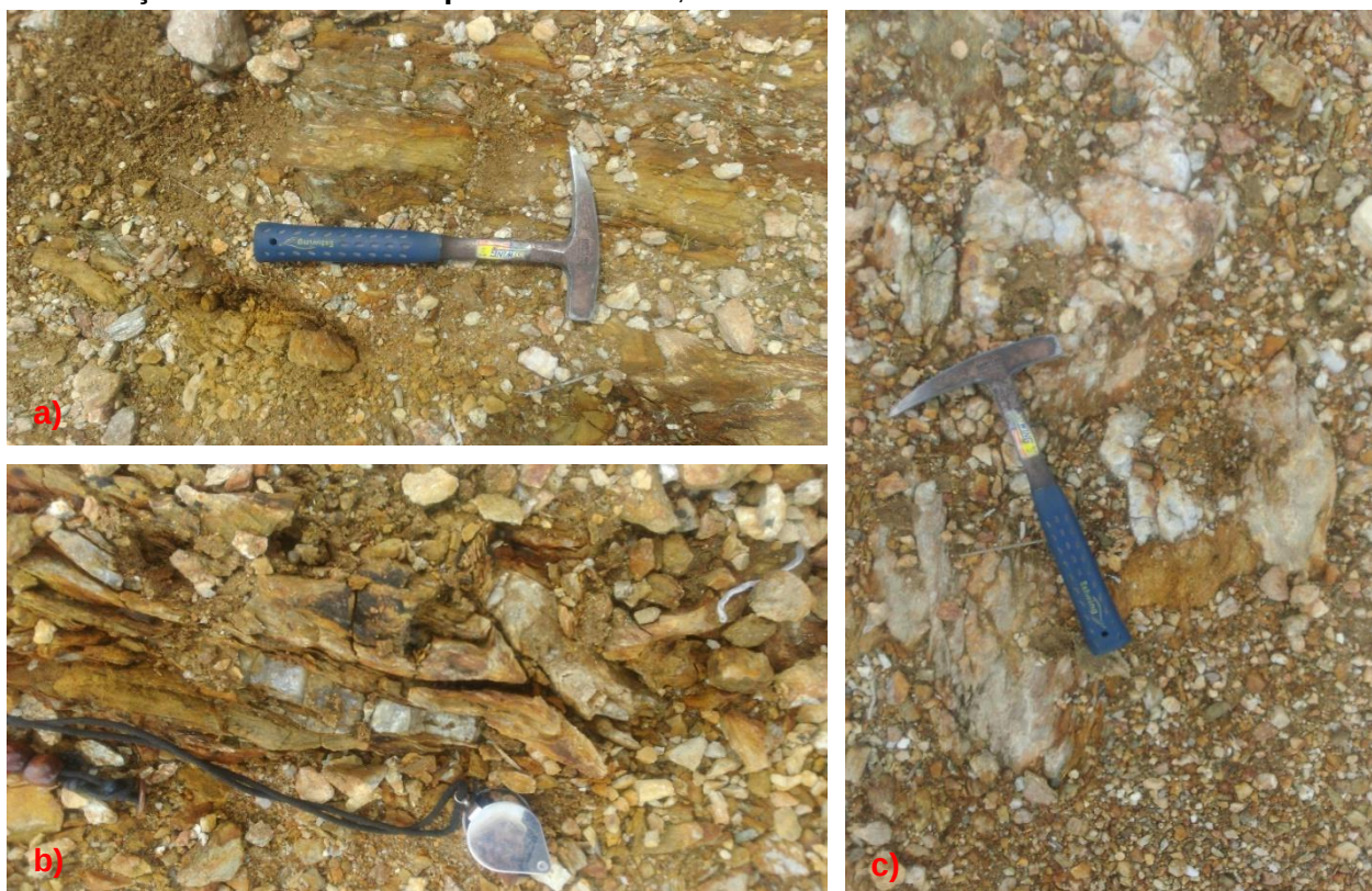
Figura 17 - a) Xisto com laminação, de cor amarelo esverdeado; b) Xistos com intercalações de quartzito em bancadas de aproximadamente 1cm; c) Massa de quartzo no xisto com cavidades de dissolução de sulfuretos
