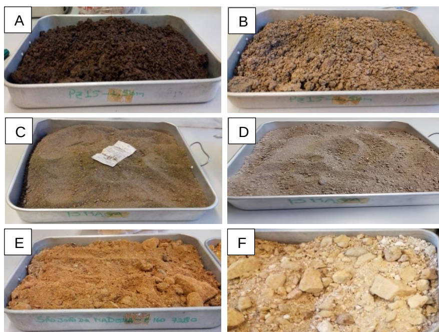
Figura 37 - Solos antes e depois de serem colocados na estufa. A – Solo “Porto” húmido; B – Solo “Porto” seco; C – Solo “Braga” húmido; D – Solo “Braga” seco; E - Solo “São João da Madeira” húmido; F – Solo “São João da Madeira” seco.
