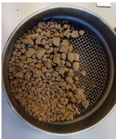
Figura 39 - Redução da amostra para inferior a 4 mm através do peneiro de malha de 4 mm.
