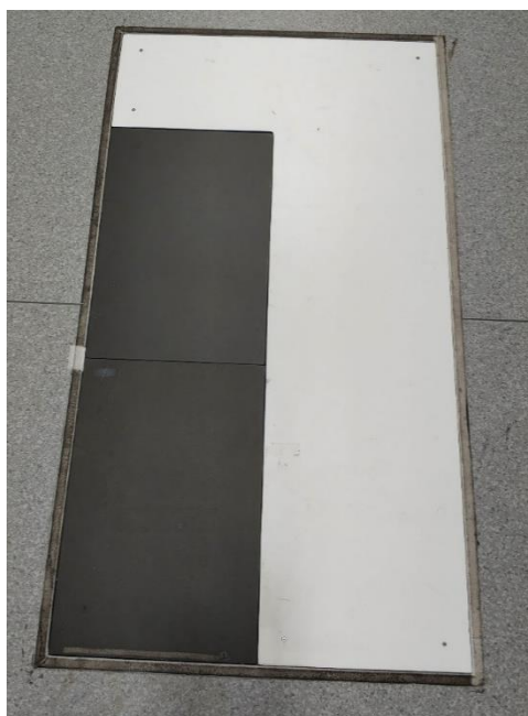
Figura 6) Plataforma de forças do Laboratório de Reabilitação da ESTSP
