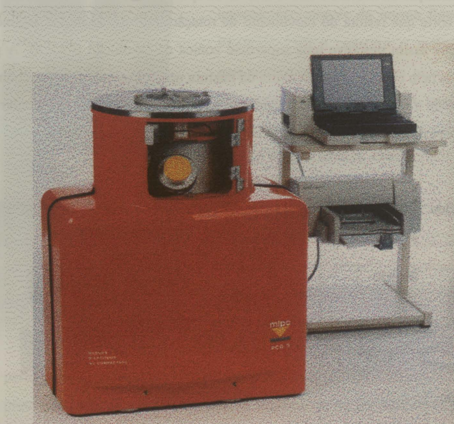
Fig. 2.9 Compactador giratório (PCG) desenvolvido no LCPC
