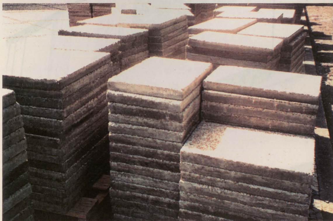
Fig. 5.10- Armazenamento de placas prefabricadas de betão
