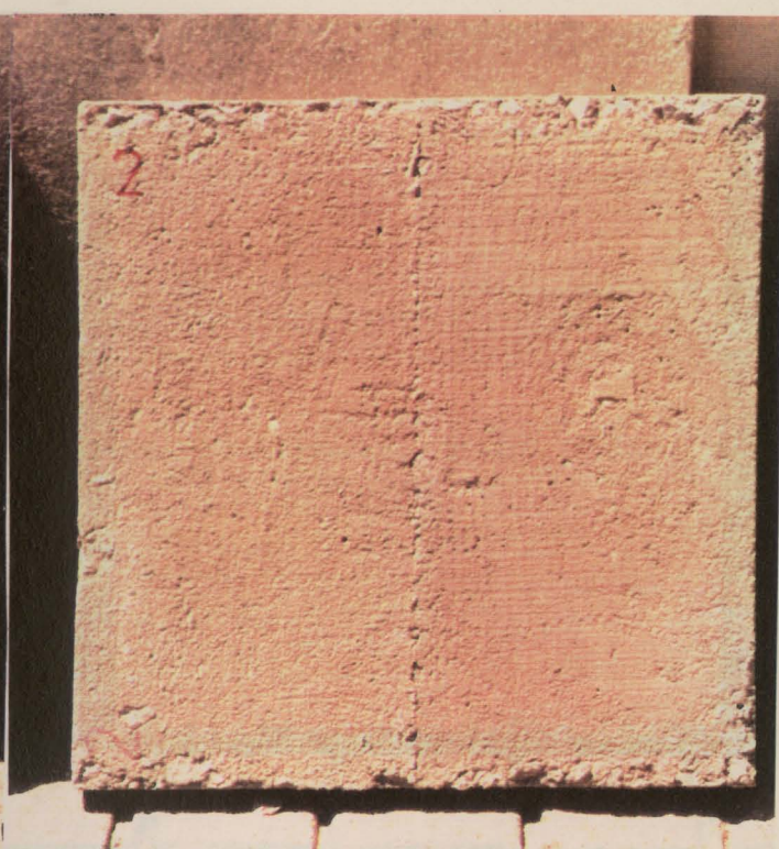
Fig. 6.6- Composição I Cofragem-madeira aparelhada
