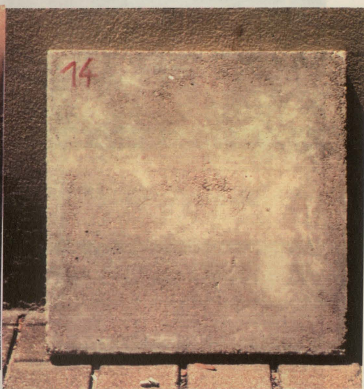
Fig. 6.18- Composição IV Cofragem-metal
