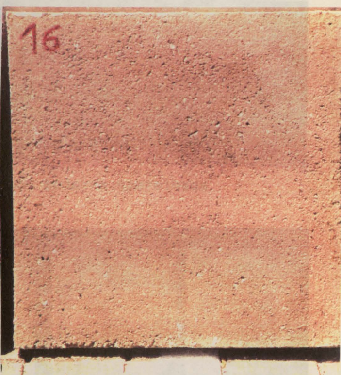
Fig. 6.20- Composição IV Cofragem-platex
