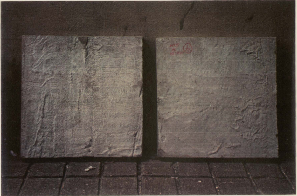
7.2- Fig. 6.25- Faces opostas à superfície cofrada
