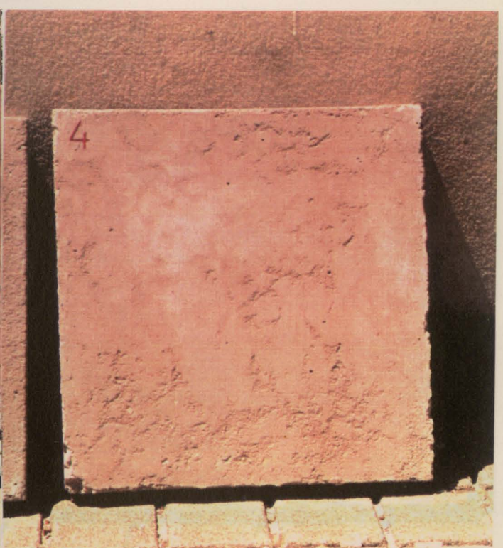
Fig. 6.8- Composição I Cofragem-metal
